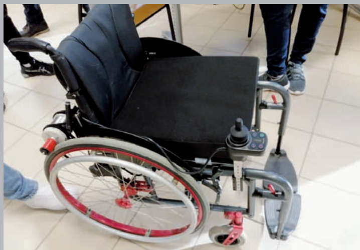
Le fauteuil motorisé. Au premier plan, l'un des moteurs en pression sur le bandage de la roue et le joystick assurant la commande électrique de l'ensemble.
