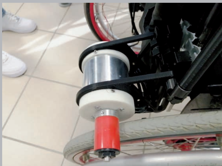
Détail du moteur fixé sur un berceau lié au dossier du fauteuil. L'ensemble est démontable facilement.
