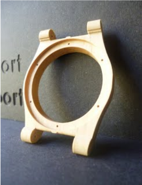
Développement CAO et Prototypage CN d'un boîtier de montre
